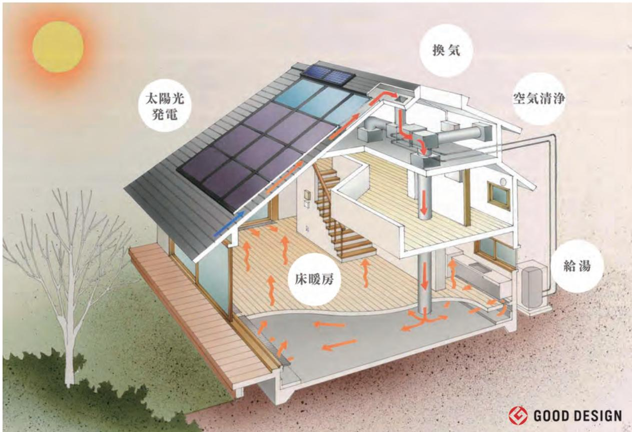
発電・暖房・換気・給湯の4つの働きで省エネと快適を OMクワトロソーラー
